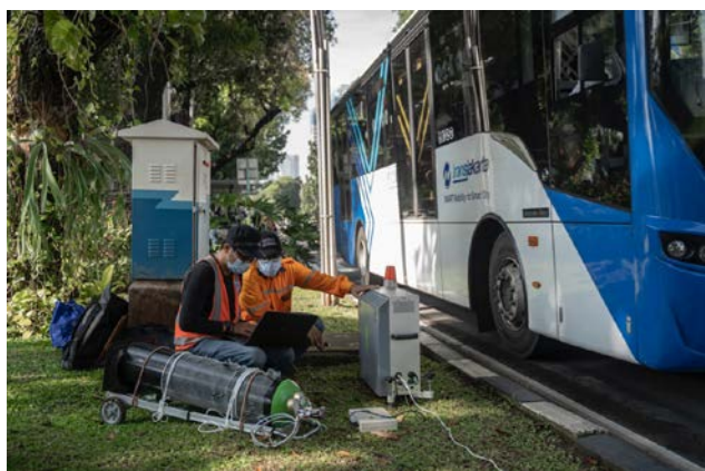
Gambar 3. Peralatan penginderaan jauh yang dipasang di jalur khusus BRT TransJakarta. Kredit foto: ICCT, 2021.
