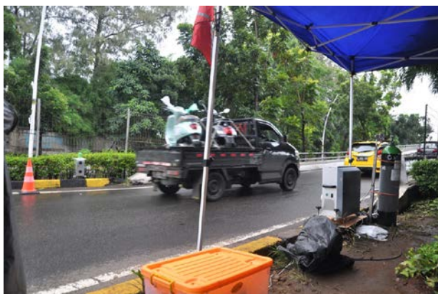
Gambar 2. Peralatan penginderaan jauh yang dipasang di lokasi JKT 01 (gerbang tol Cempaka putih). Kredit foto: Aditya Mahalana - ICCT/2021.
